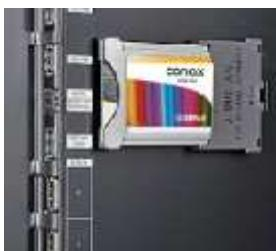
CI slot v televizním přijímači najdete většinou po straně nebo na zadním panelu Vašeho televizoru, obvykle poblíž dalších rozhraní. (HDMI, USB)
